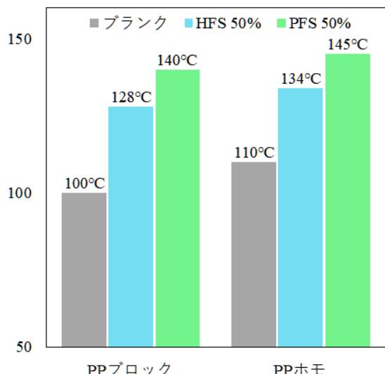
荷重たわみ温度(0.45 MPa)の変化
